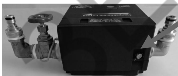
Рисунок 4 – Места нанесения знака поверки на установки модификации УППА-2А и УППА-3А
