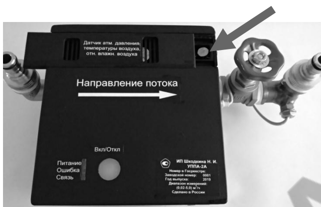
Рисунок 4 – Места нанесения знака поверки на установки модификации УППА-2А и УППА-3А
